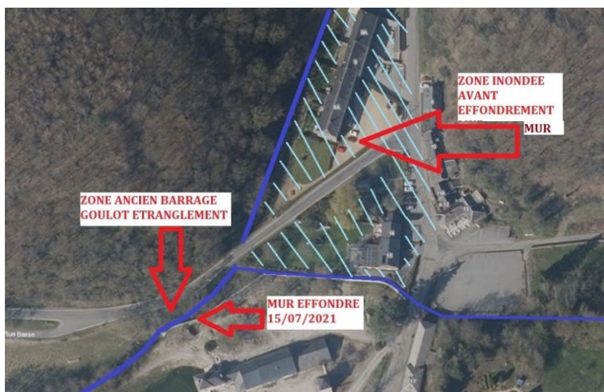
Fig. 23. Zones et habitations inondées avant l'effondrement du mur. La zone hachurée correspond à la hauteur du mur avant effondrement. © P. ANDRÉ.
