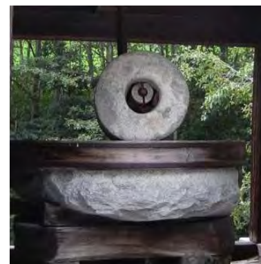
Fig. 5. Le broyeur de chanvre de Steinach (Forêt Noire) utilisé jusqu'en 1929. http://fr.vogtsbauernhof.de .
