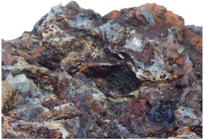
Figure 14, Inclusions de charbon de bois qui sont encore présentes dans une grande scorie de la forge de Crupet; © Collection ANDRE P.
