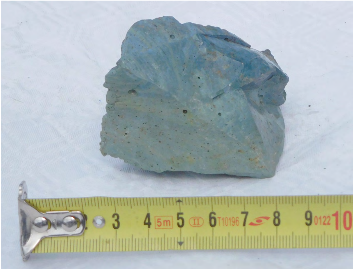
Figure 48, Scorie bleutée et vert d'eau, ancienne forge de Crupet;© Collection ANDRE P.
