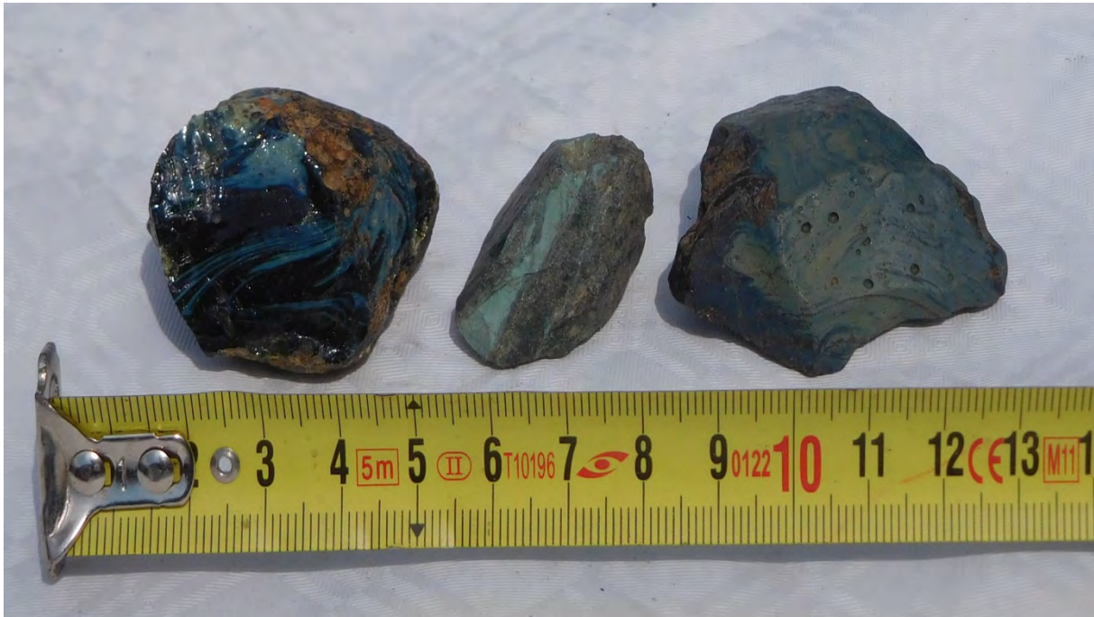
Figure 43, Scories bleutées ancienne forge de Crupet trouvées dans le lit de la rivière;© Collection ANDRE P.
