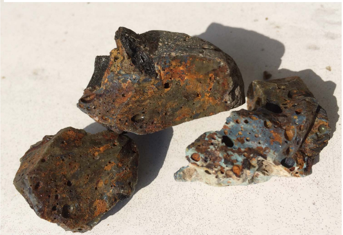
Figure 39, Scories bleutées-verdâtres rouillées avec présences de bulles et inclusions de charbons de bois © Collection ANDRE-DUMONT Florence.
