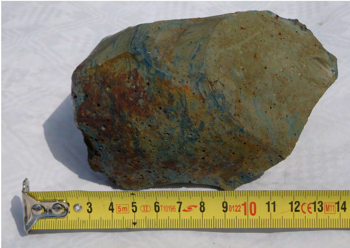
Figure 29, Scorie ancienne forge de Crupet avec oxyde de fer en surface;© Collection ANDRE P.
