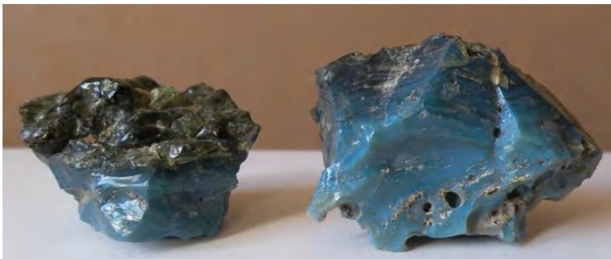
Figure 19, Scories vitreuses bleues d'anciennes fonderies du moyen âge;© minero.over-blog.com.
