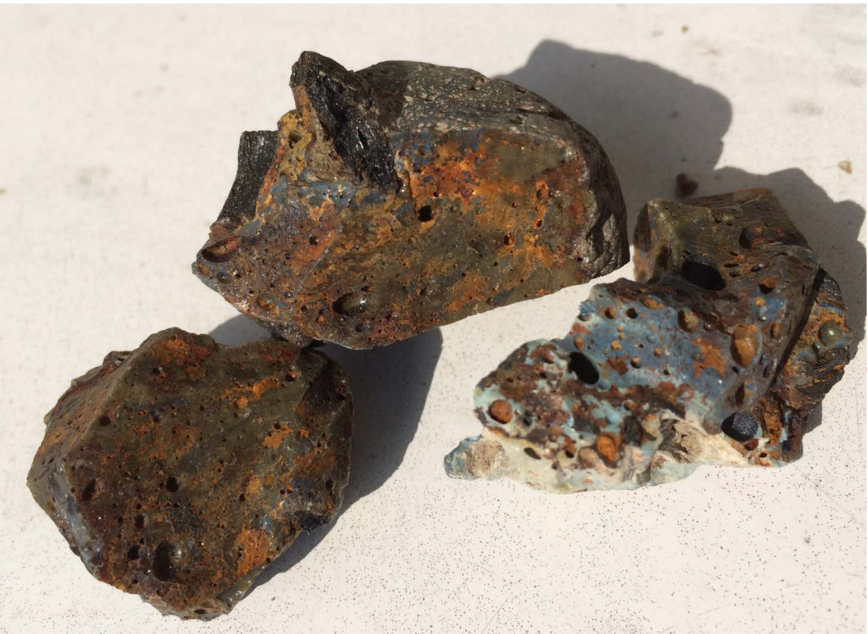
Figure 51, Scories fortement rouillées avec charbon de bois saillants en haut;© ANDRE-DUMONT Florence.
