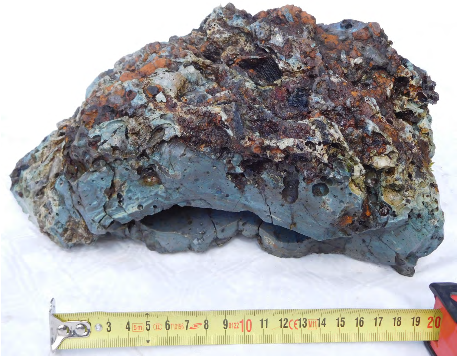
Figure 26, Scorie bleutée de très grande dimension, avec inclusions de charbon de bois encore présent, oxyde de fer en surface, conglomérats métalliques à certains endroits, gangue vitreuse et restes calcaires, ancienne forge de Crupet; © Collection ANDRE P.
