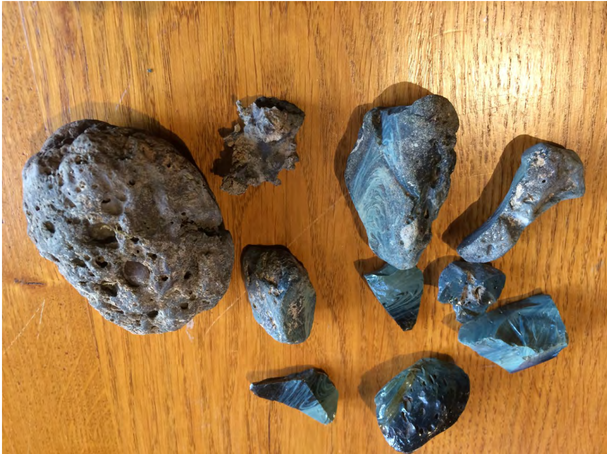
Figure 1, Scories ou machefers ou crayats de l'ancienne forge de Crupet retrouvées dans la ruisseau le Crupet à hauteur de Venate à plus d'un kilomètre de la forge;© Collection ANDRE-DUMONT Florence.
