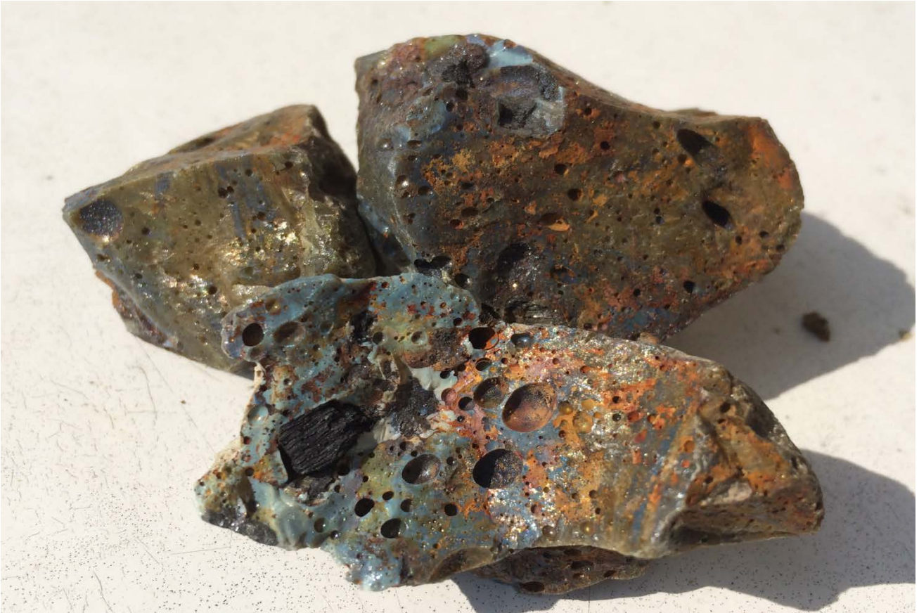
Figure 38, Scories bleutées-verdâtres rouillées avec présences de bulles et inclusions de charbons de bois © Collection ANDRE-DUMONT Florence.
