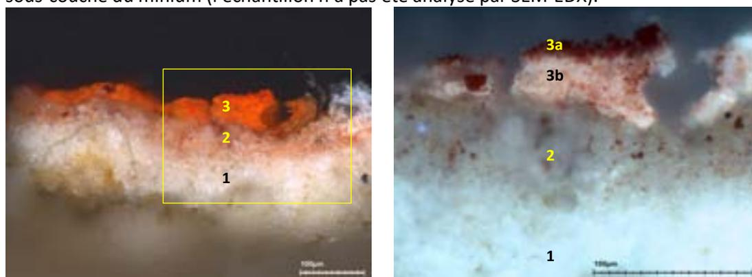
**Fig. 4 :** Microphotographie de la coupe stratigraphique de l'échantillon n°2 prise par microscopie optique sous lumière visible polarisée à grossissement 200x et sous lumière UV à 500x. ©KIK-IRPA Laboratoire des polychromies.
