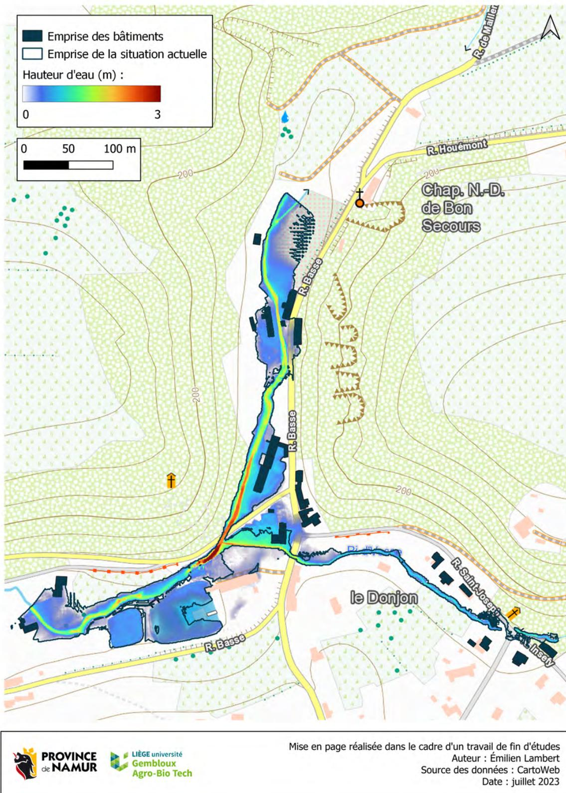
FIGURE 57 – Répartition des hauteurs d'eau pour le scénario 2 - reconstruction totale du mur.
