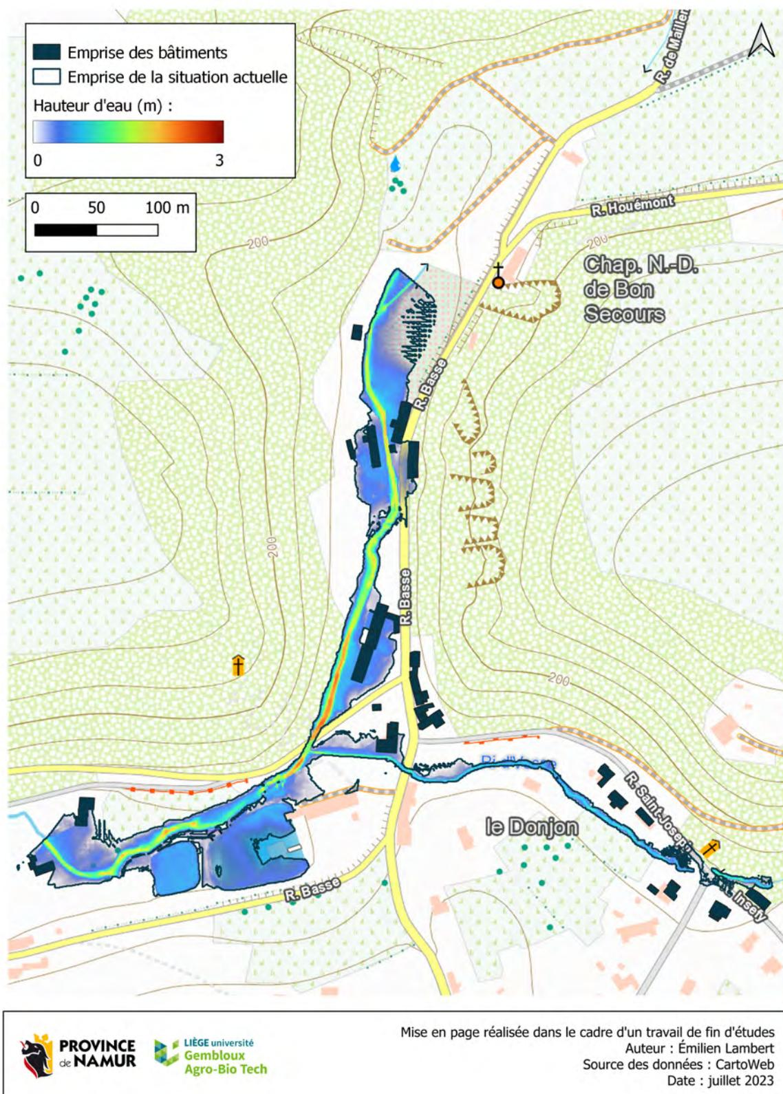
FIGURE 56 – Répartition des hauteurs d'eau pour le scénario 1 - situation actuelle.
