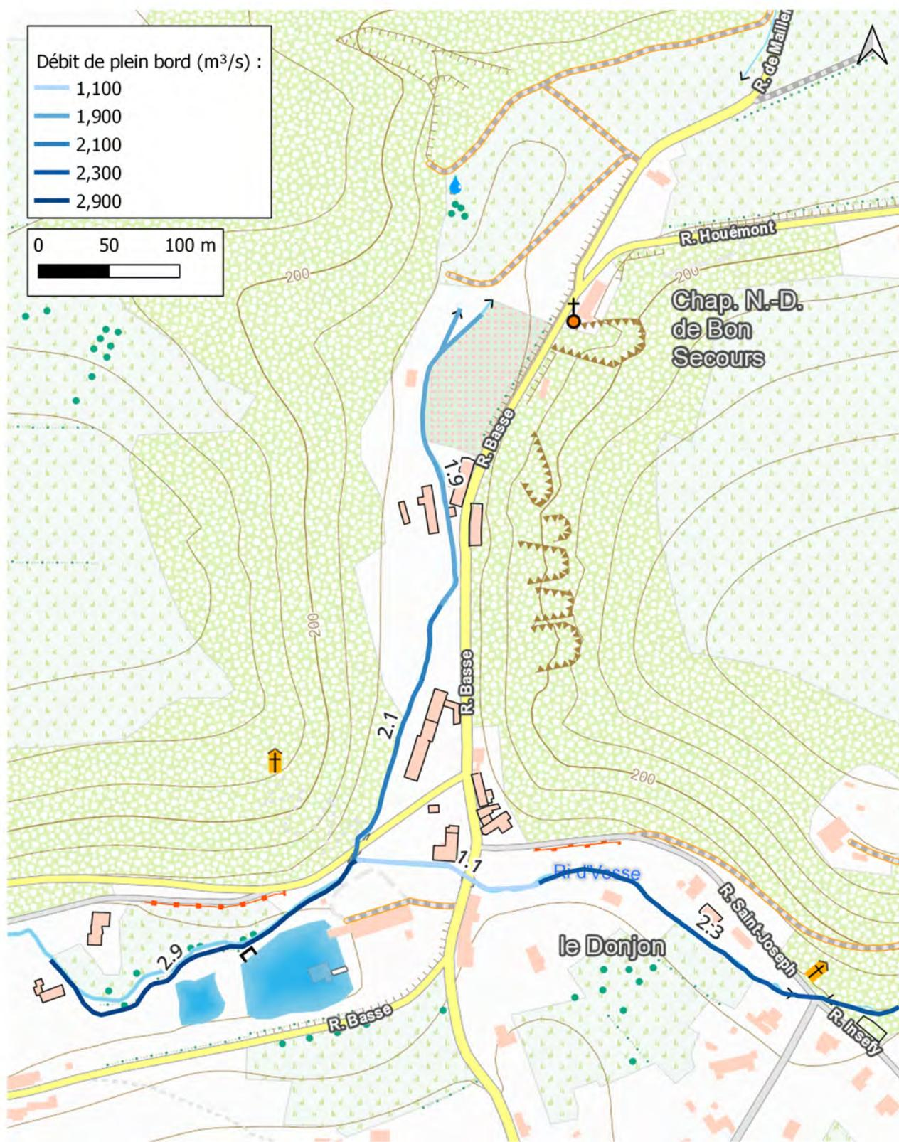
FIGURE 51 – Carte des débits de plein bord (débit maximal avant débordement).
